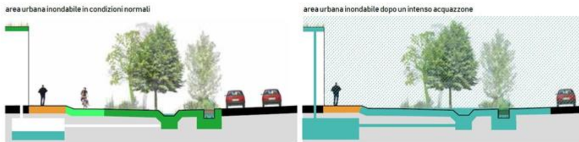
Fig. 6- Soluzioni SUDS per la raccolta acque nelle strade urbane (Fonte: SOS4LIFE, linee guida per la rigenerazione urbana)
